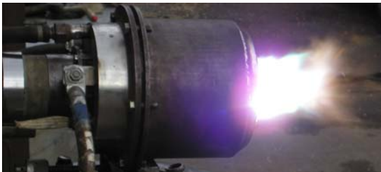
Fig. 1. Long life DC arc plasmatron
